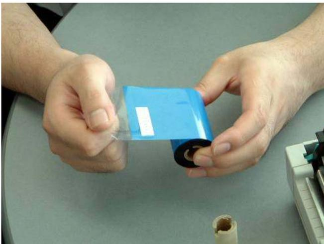
③リボンを取り付ける準備を行います。透明の部分を剥がします。
