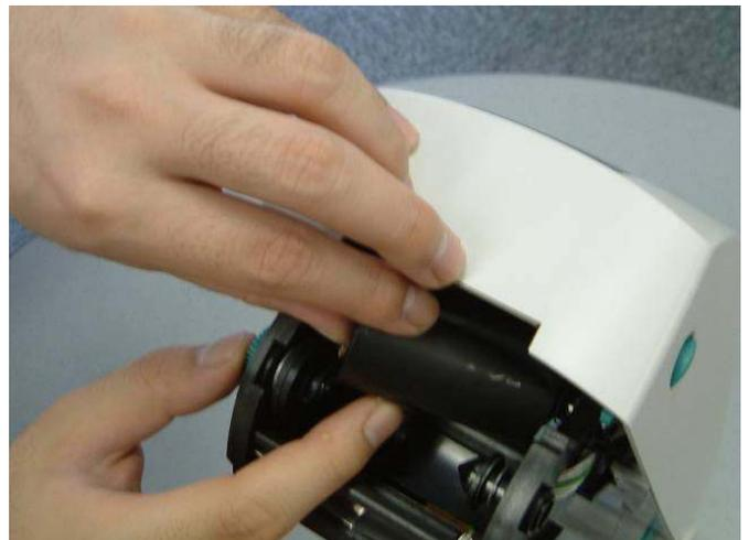
⑥リボンが通ったらリボンカバーの奥の止具へ右側から取り付けます。
