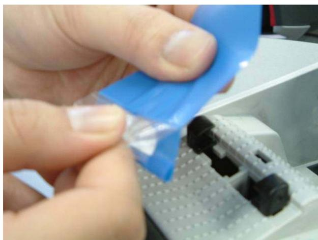
⑩リボンが固定されたら先ほどリボンカバーから通した透明のセロハンを剥がします。
